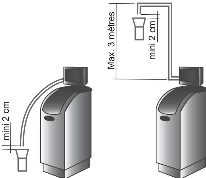
Conformément aux prescriptions des règlements sanitaires, une rupture de charge au moins égale à 2 cm devra être prévue entre le tuyau de mise à l'égout de l'adoucisseur et la canalisation principale d'égout suivant le schéma ci-contre.
