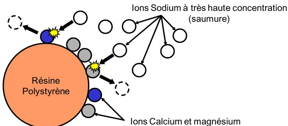
Les ions Sodium regagnent leur place sur la résine. Les ions Calcium et Magnésium expulsés repassent dans l'eau qui est rejetée à l'égout.
