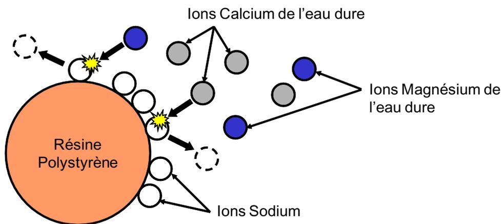
Les ions Calcium et Magnésium remplacent les ions Sodium sur la résine. Ceux-ci sont libérés dans l'eau, qui devient douce.
